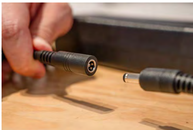
连接DC口与DC转XT60转接头
